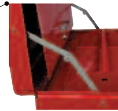
Podpory pokrywy zapewniają jej utrzymanie w pozycji pionowej podczas pracy.
