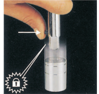
Wciśnij ponownie aby swobodnie wyjąć trzpień z nasadki
