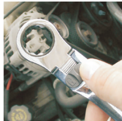
Jednopalcowy przełącznik blokady położenia grzechotki
